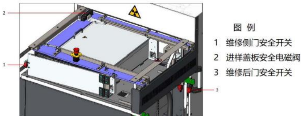
图 10-4 高压门机联锁设计图
