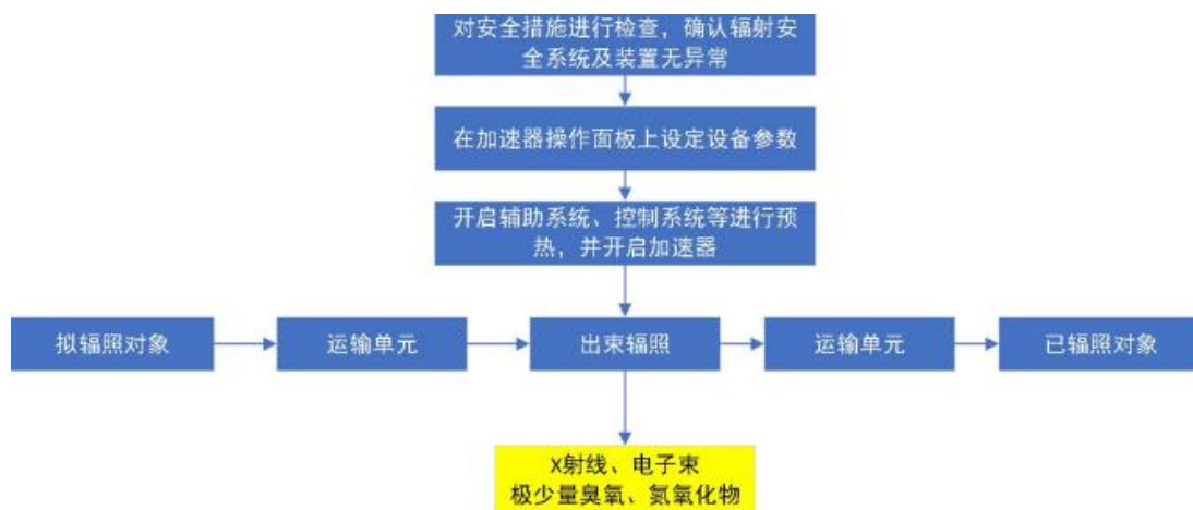
图 9-4 本项目辐照固化工艺流程示意图
