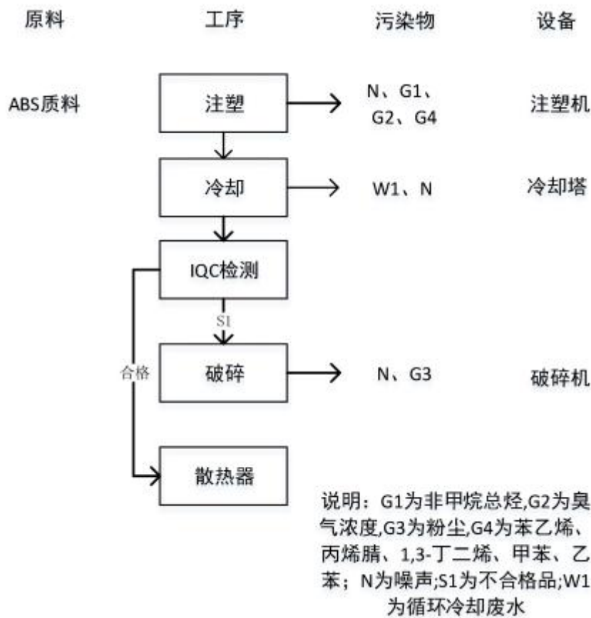
图 2-7 原项目散热器工艺流程图及产污环节
