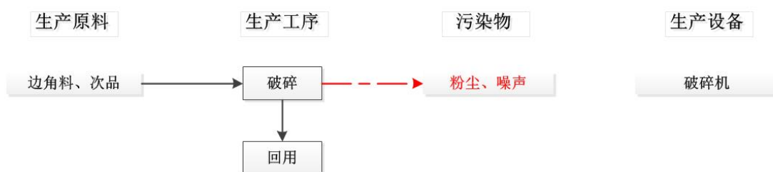
图 2-4 本项目破碎工艺流程及产污环节图
