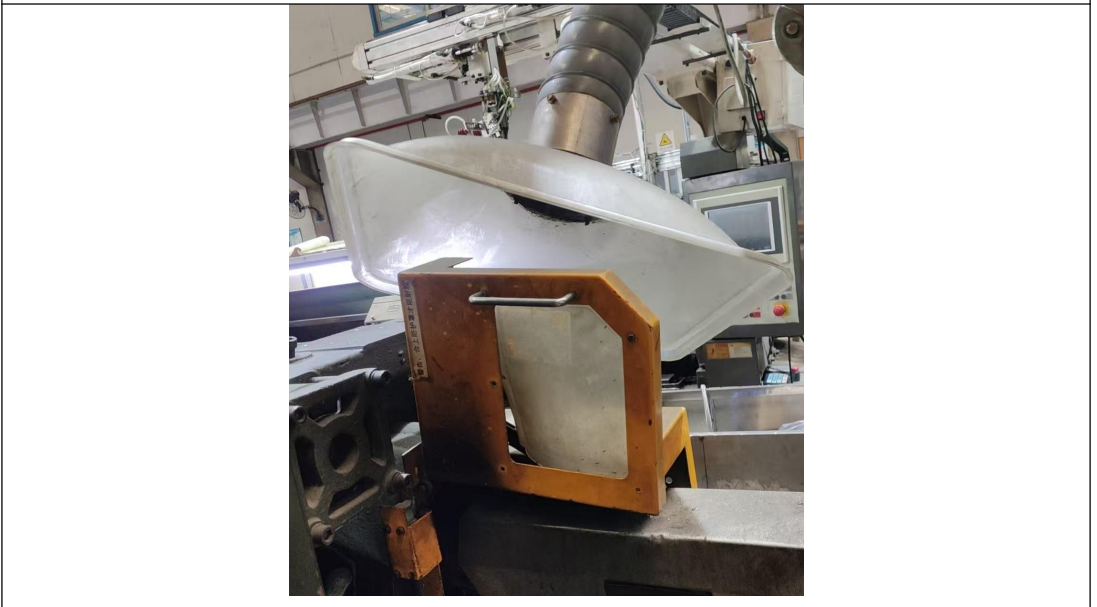
图 4-2（2） 本项目集气罩示意图
