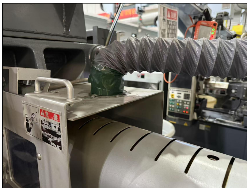
图 4-1 注塑机集气设备示意图
