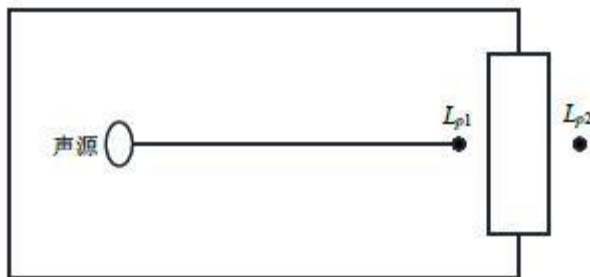
图 4-3 室内声源等效为室外声源图例
