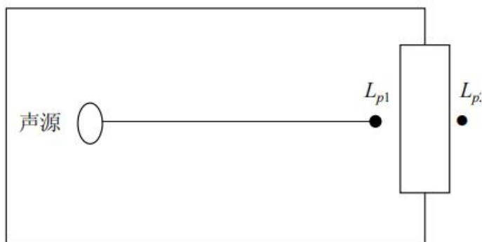
图 4-1 室内声源等效为室外声源图例
