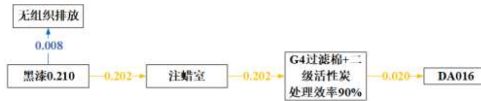
图 3.3-2 现有项目甲苯平衡图 单位: t/a
