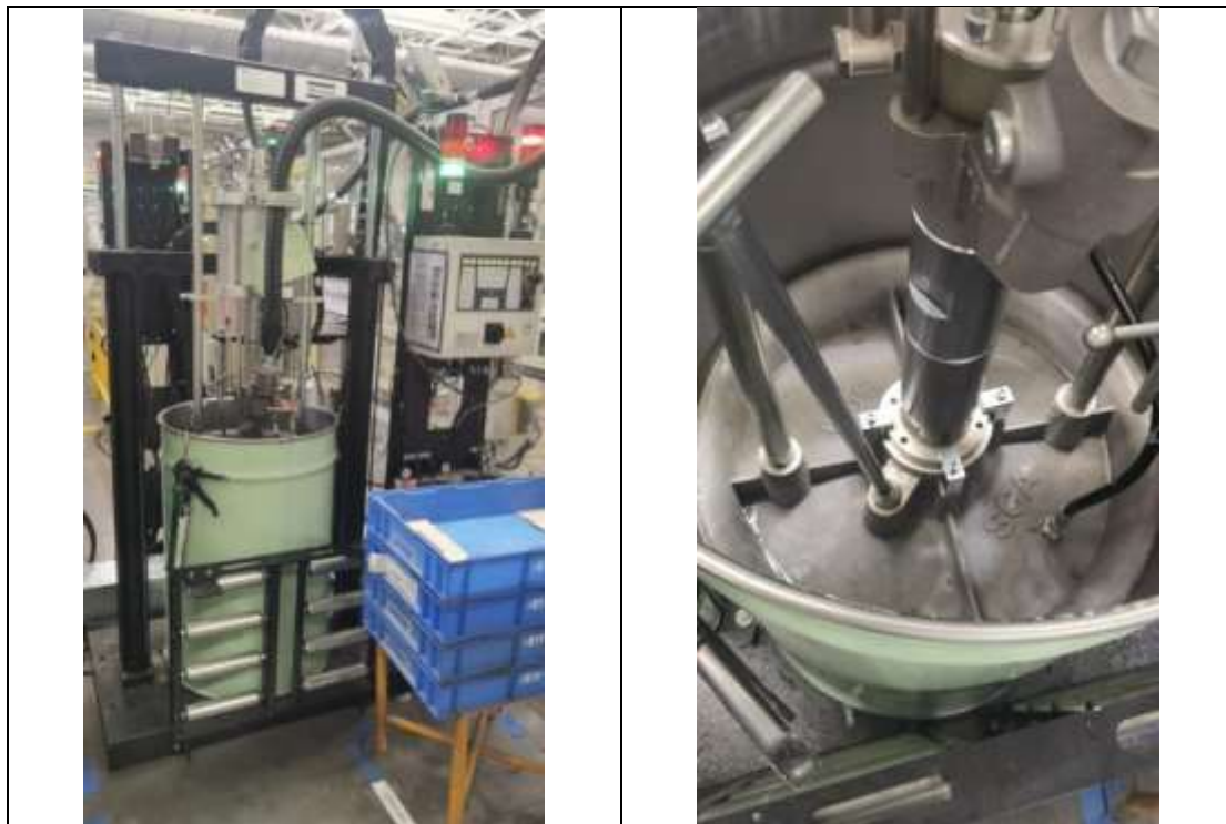
图 4.4-16 焊装车间用胶工序工作状态图
