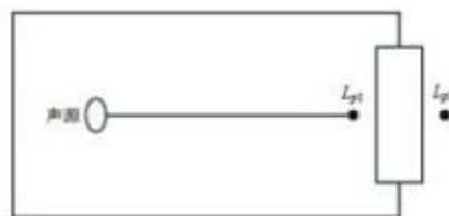
图 4-2 室内声源等效为室外声源图例
