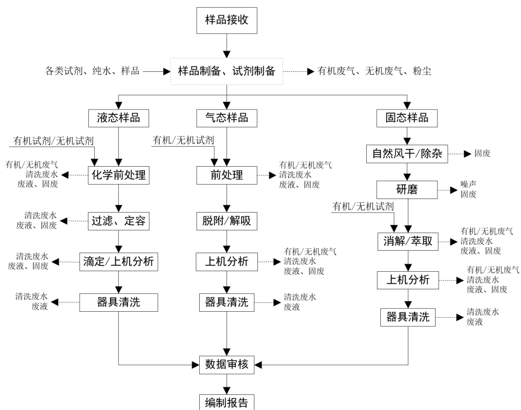
图 2-2 项目实验室分析检测的工艺流程及产污环节图
