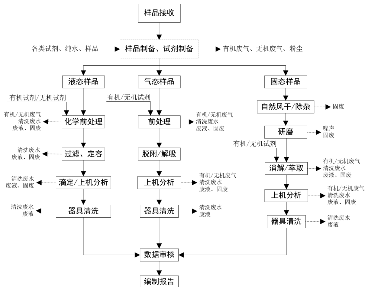
图 2.2-2 项目实验室分析检测的工艺流程及产污环节图
