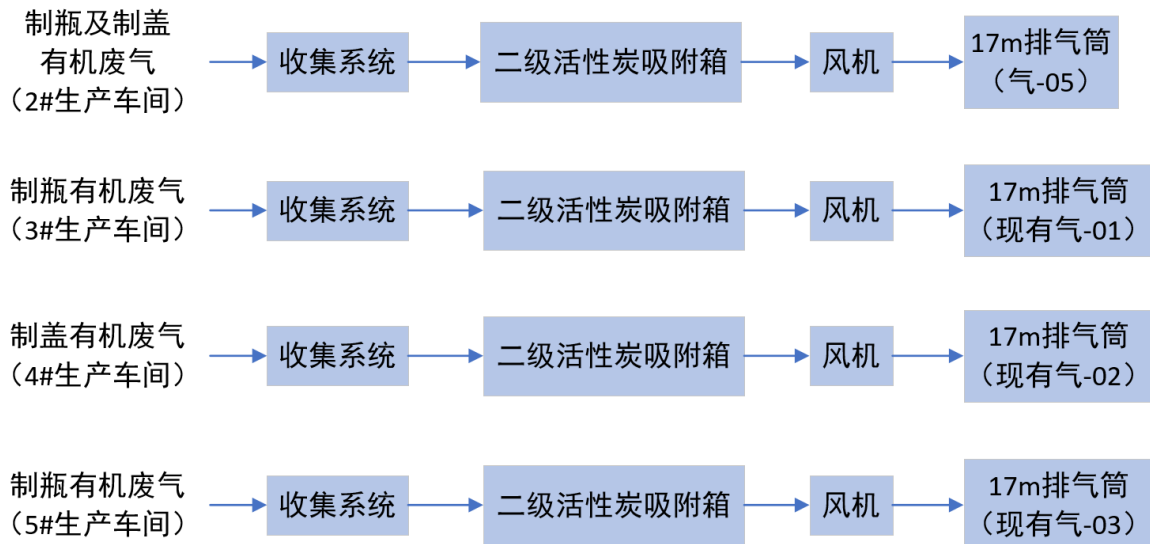
图 4-1 改扩建后的制瓶及制盖有机废气处理工艺流程图
