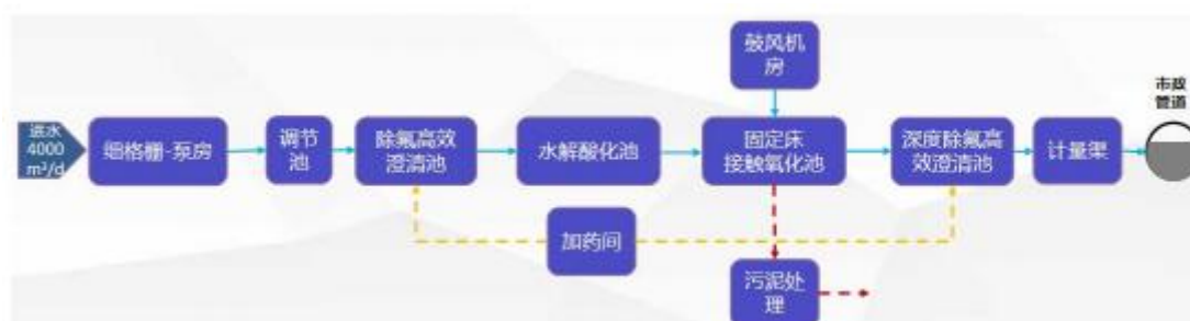
图 6.2-1 废水处理总体工艺路线框图
