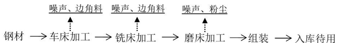
图 2-3 原项目（模具加工）生产工艺流程与产污环节示意图
