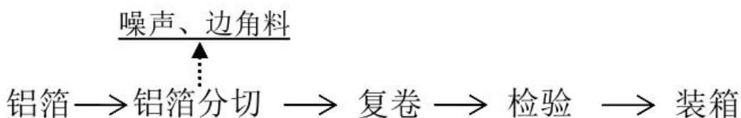
图 2-5 原项目（家用铝箔卷、 烧烤铝箔卷）生产工艺流程与产污环节示意图
