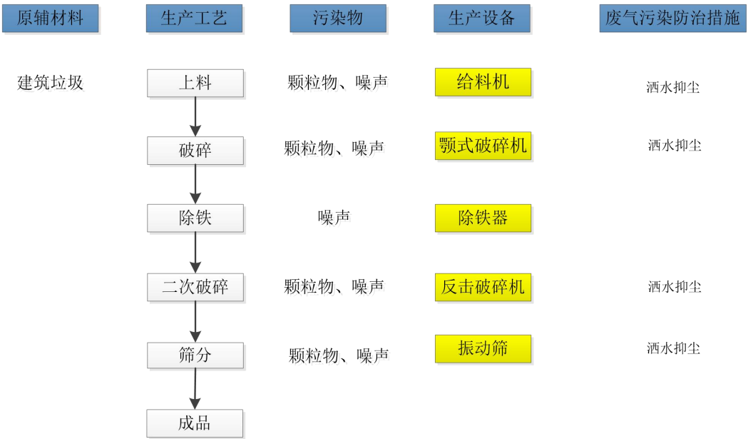
图 2-1 本项目建筑垃圾处理工艺流程及产污环节示意图
