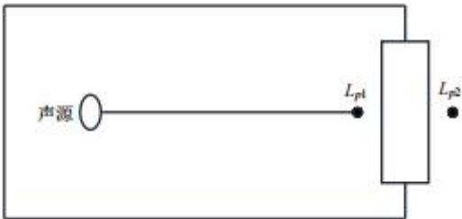
图 4-2 室内声源等效为室外声源图例
