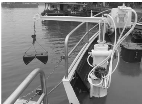
图 8 底质、水生物样品采集专用电动吊杆设备
