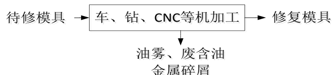
图 2-4 模具维修工艺流程图
