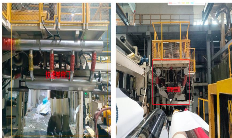
图 2-4 淋膜废气收集改造方案图
