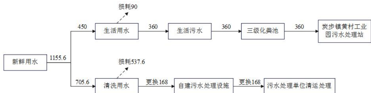
图 2-1 项目水平衡图（单位：m 3 /a）
