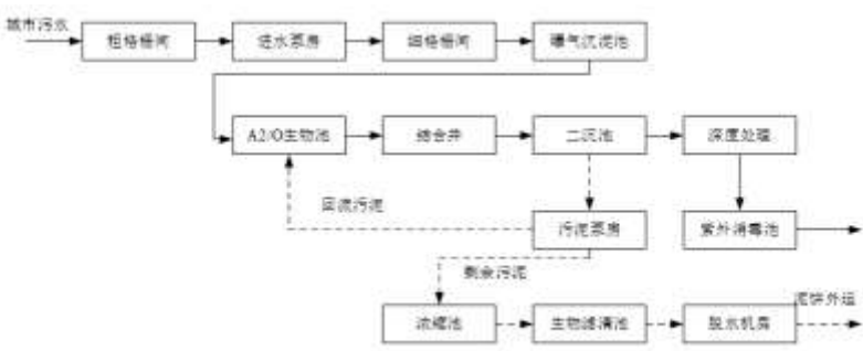
图 4-2 江高净水厂废水处理工艺
