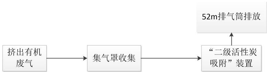
图 4-1 项目废气处理工艺流程图
