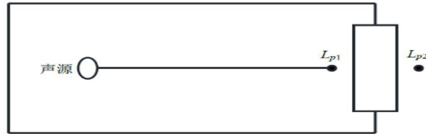
图 4-2 室内声源等效为室外声源图例
