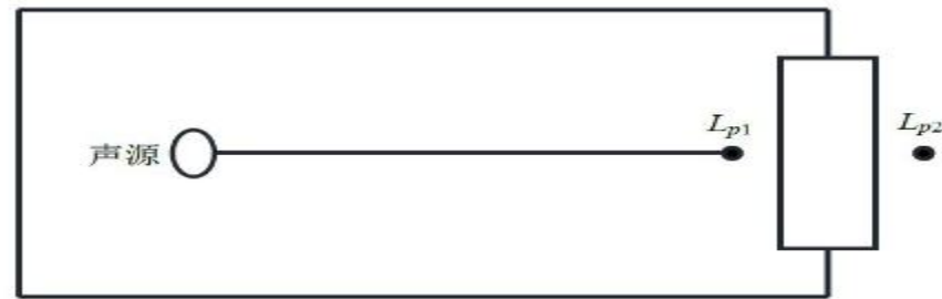
图 4-3 室内声源等效为室外声源图例
