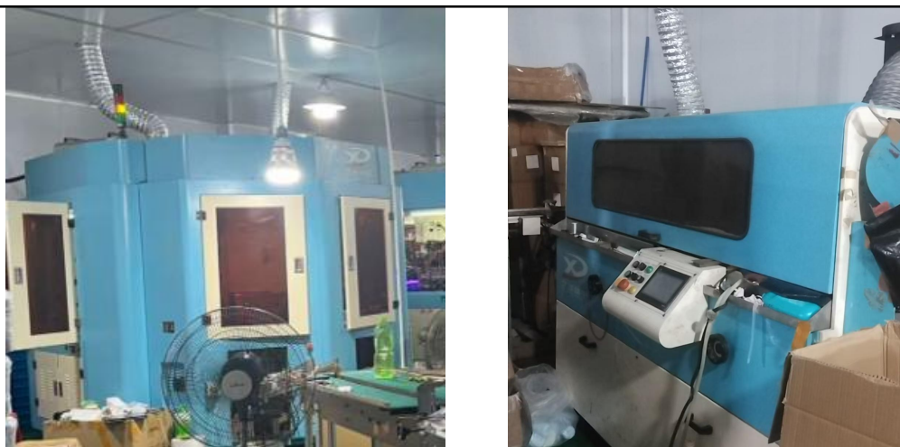
图 4-2 项目全自动丝印机设备密闭示意图
