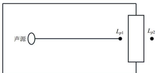
图 4-1 室内声源等效为室外声源图例
