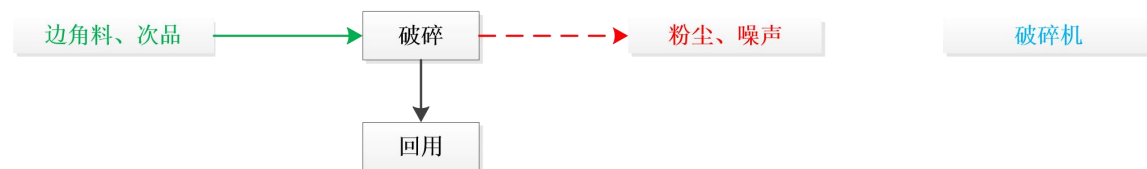
图 2-4 本项目破碎工艺流程及产污环节图
