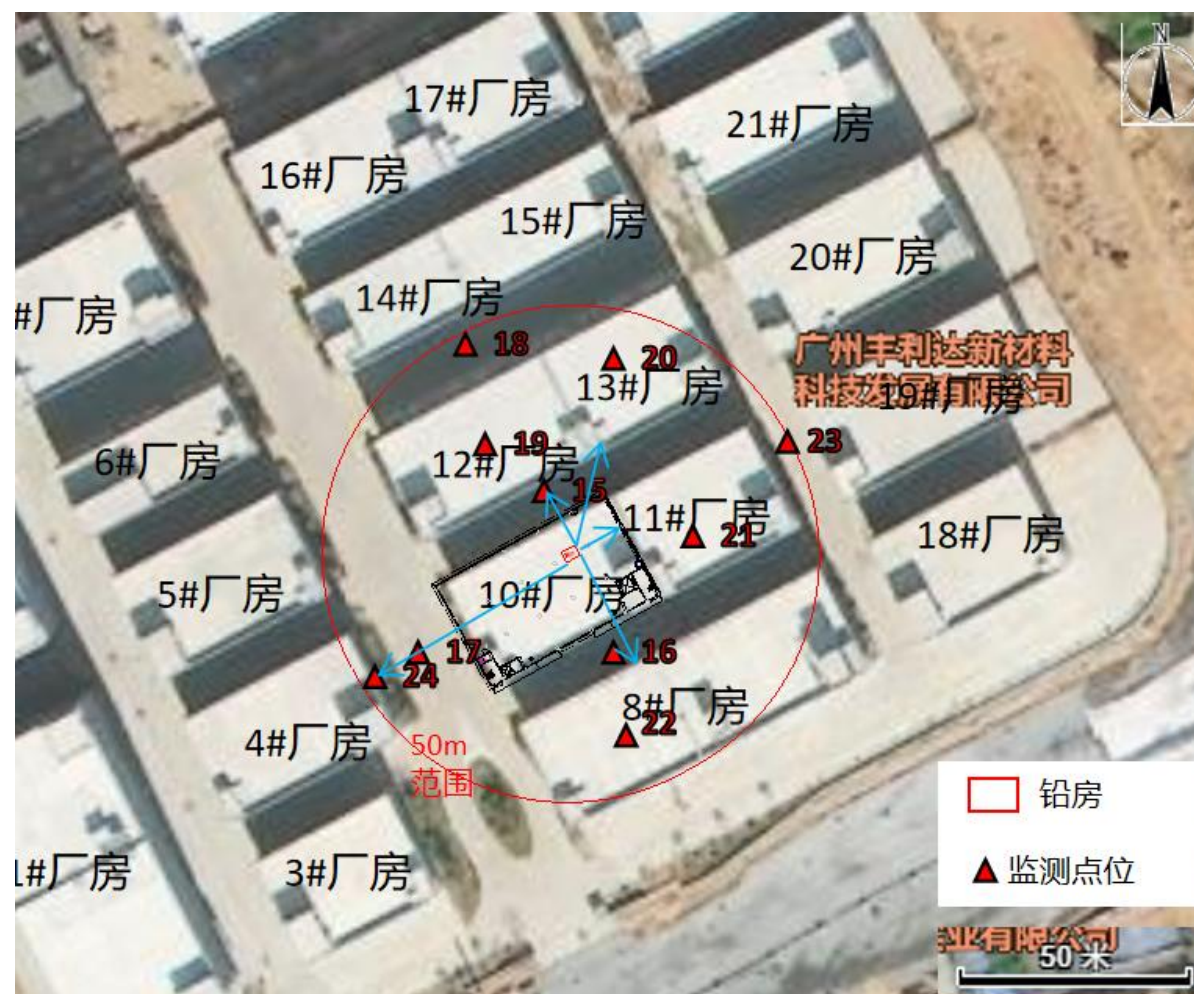
图 8.2-2 铅房位置及周围 \gamma 辐射剂量率检测布点图 (10# 厂房室外)
