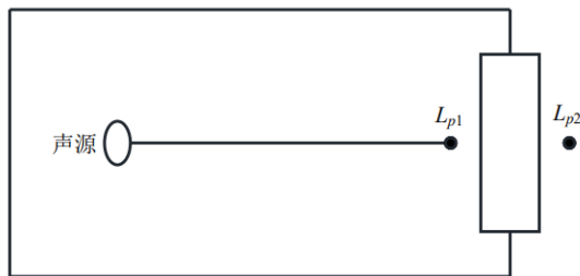
图 4-2 室内声源等效为室外声源图例
