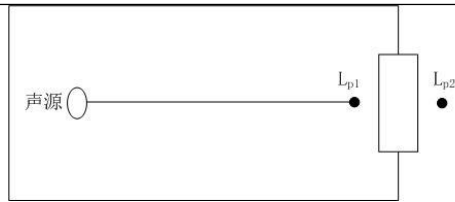
图 4-4 室内声源等效为室外声源图例
