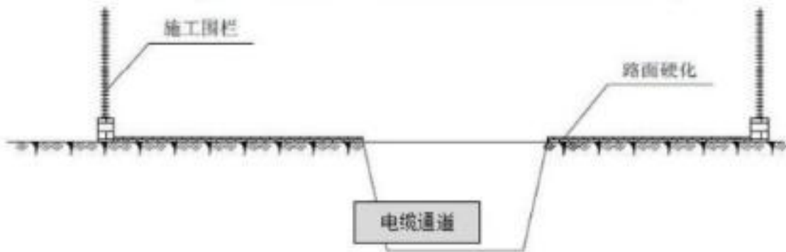
人行道区域完工后水土保持措施剖面示意图
