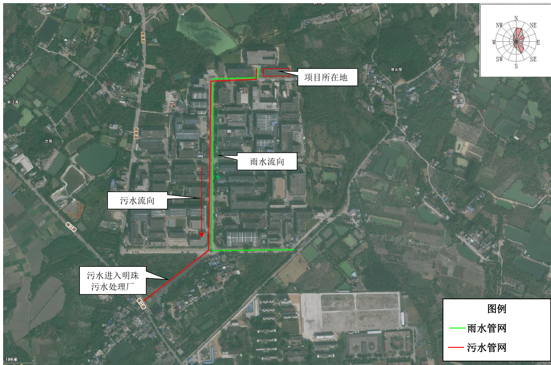
附图 18 区域雨污水管网走向图
