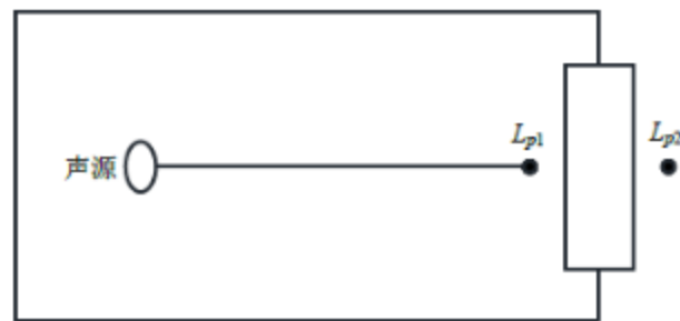
图 4-3 室内声源等效为室外声源图例
