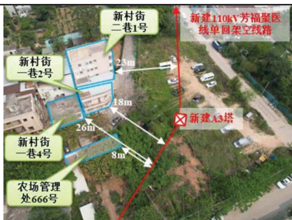
图 3- 10 本工程迁改后架空线路与环境保护目标相对位置关系图 (2/2)
