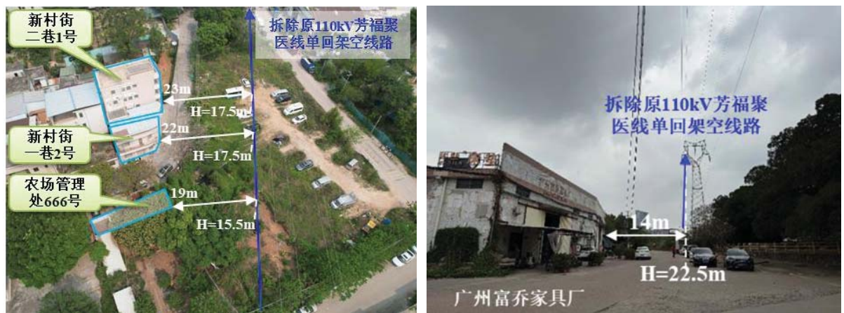
图 3- 4 本工程迁改前架空线路与环境保护目标相对位置关系图（2/2）
