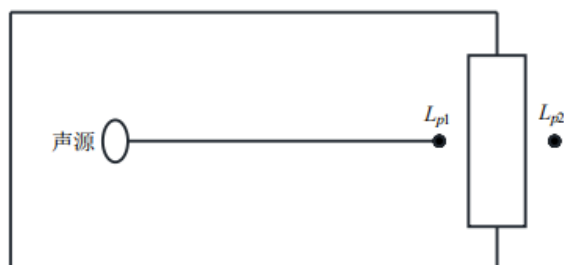
图 4-3 室内声源等效为室外声源图例
