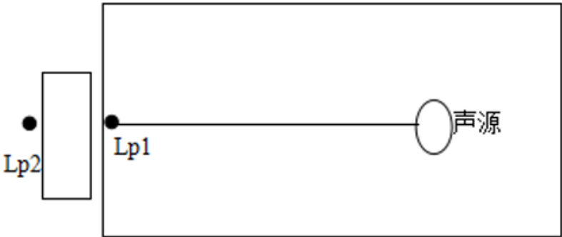
图 4-4 室内声源等效为室外声源图例
