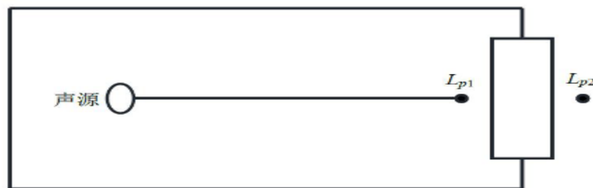
图 4-2 室内声源等效为室外声源图例
