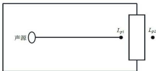
图 4-1 室内声源等效为室外声源图例
