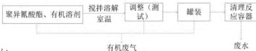
图 2-10 硬化剂研发工艺流程及产污节点图
