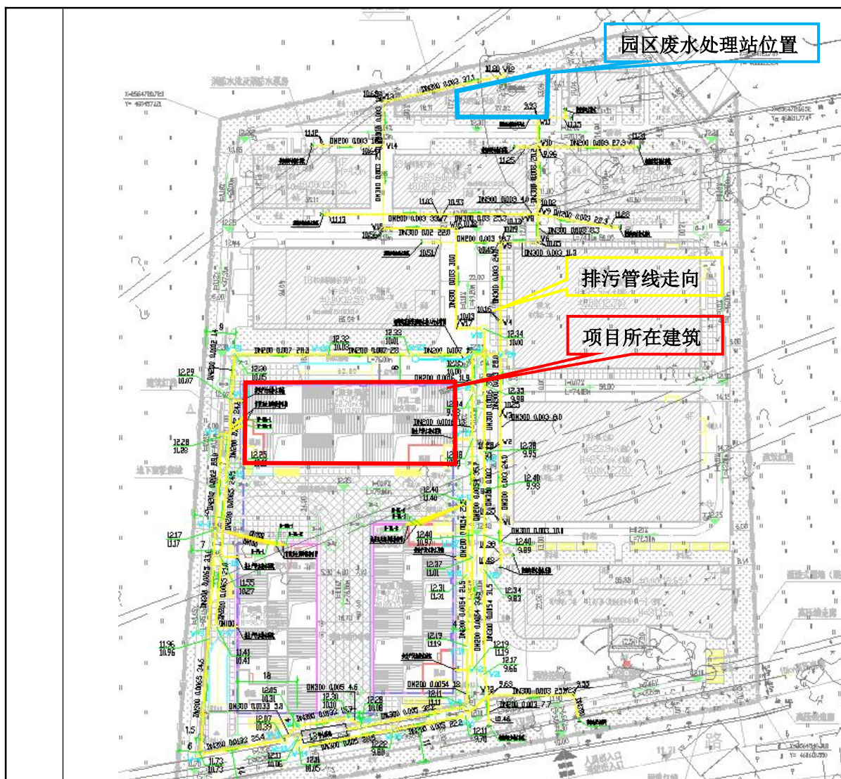
图 4-4 项目所在园区废水管网走向图
