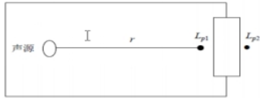
图 4-2 室内声源等效为室外声源图例
