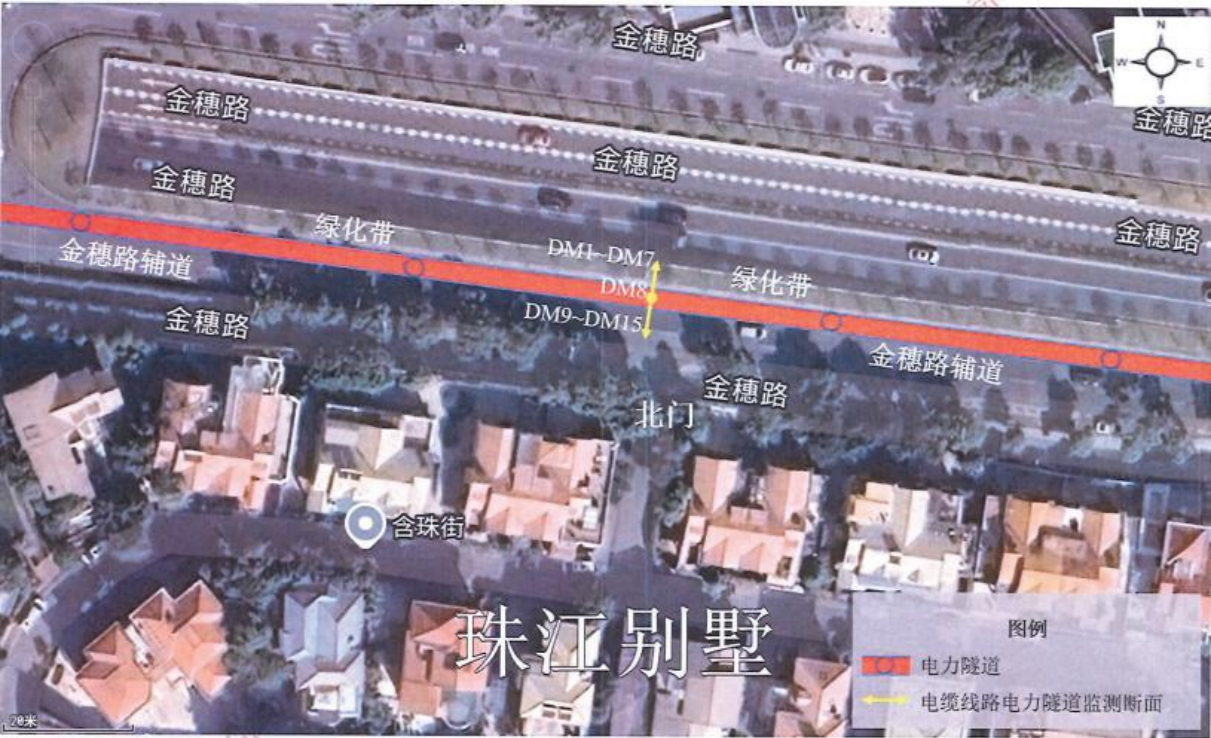
图 A-2 广州市 12 回电缆线路电磁环境监测点位图
