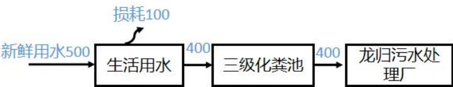
图 2-1 本项目水平衡图（t/a）
