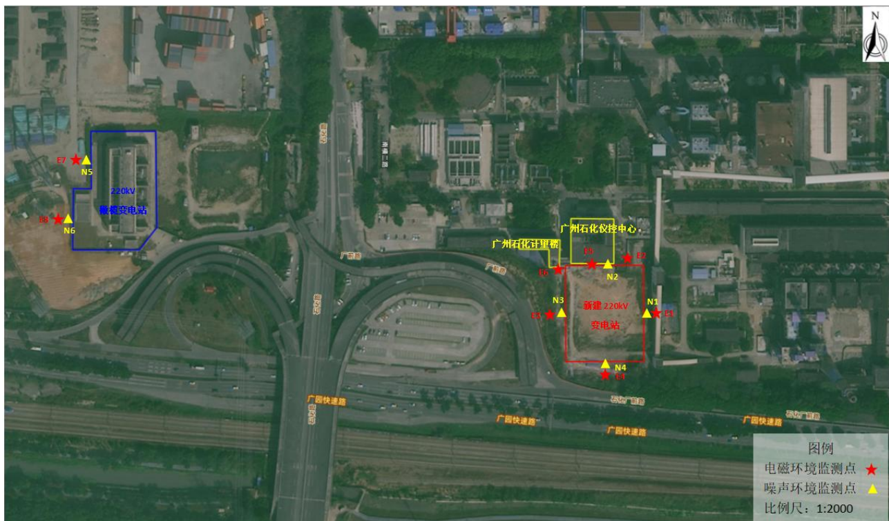
图 1 电磁环境监测布点示意图
