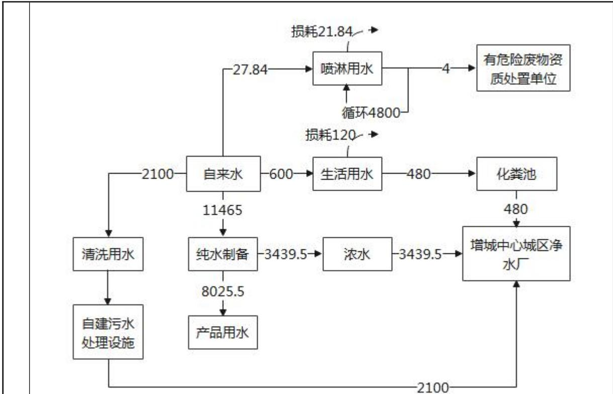
图 2-1 水平衡图 (单位: t/a)
