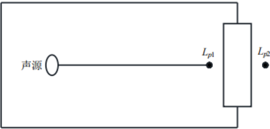
图 4-3 室内声源等效为室外声源图例
