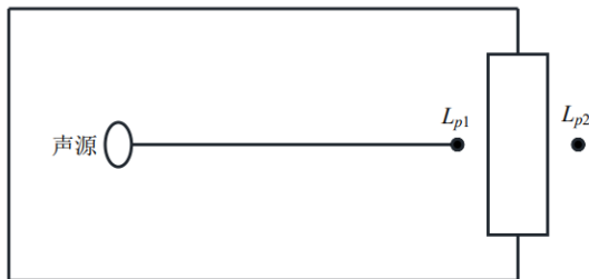
图 4-1 室内声源等效为室外声源图例
