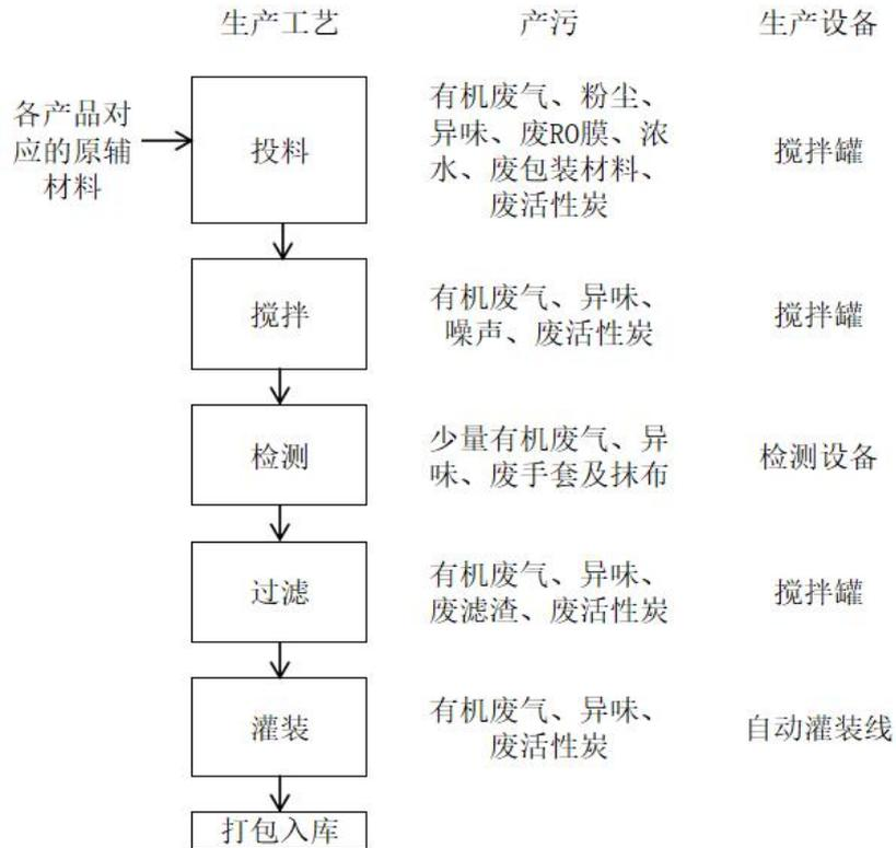
图 2-2 项目生产工艺及产污环节图
