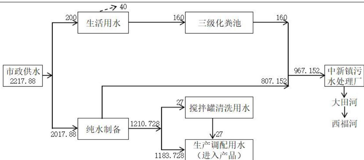
图 2-1 水平衡图 (单位  $\text{m}^3/\text{a}$ )
