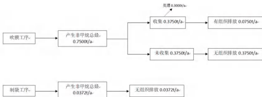
图 4-1 项目 VOCs 平衡图
