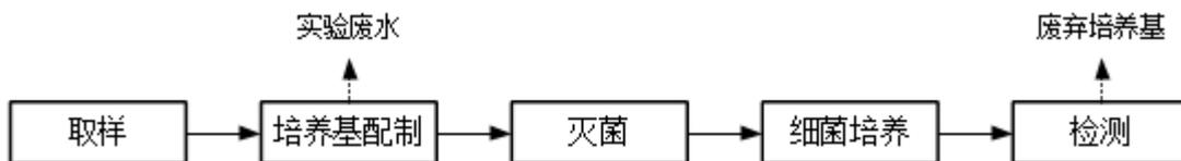
图 2-15 化验室检验流程
