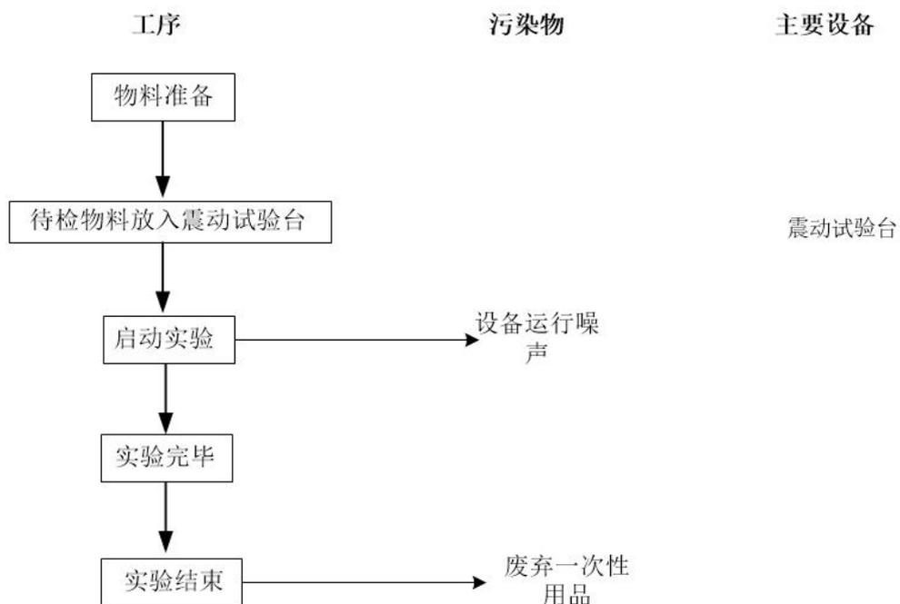
图2-4 振动试验台检测流程及产污环节示意图
