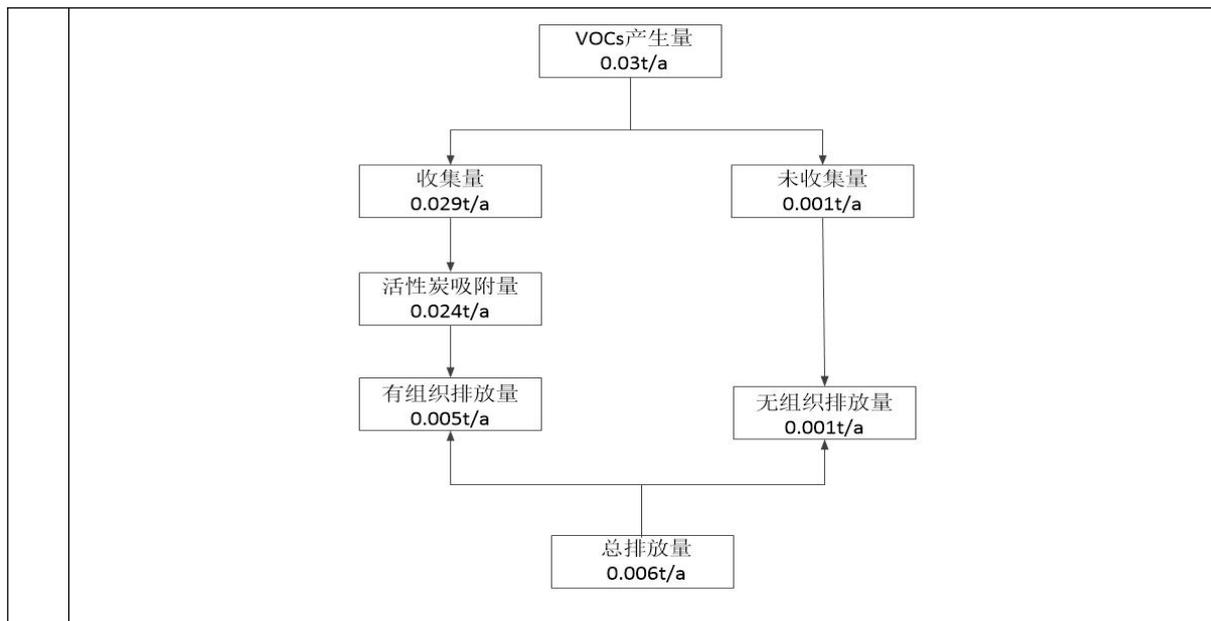
图 2-1 项目 VOCs 平衡图
