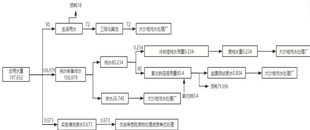
图 4-2 项目水平衡图 单位 t/a
